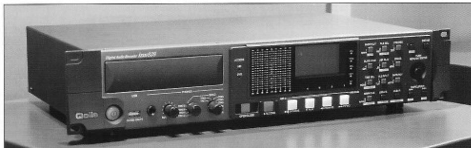
Premiere auf der Berliner AES: Qolte DVD-RAM-Recorder mit acht Kanälen für den stationären und mobilen Betrieb
